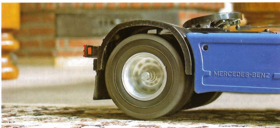
Auch bei Fahrten im Wohnzimmer kann eine Differenzialsperre hilfreich sein. Hier hängt das rechte Rad an einer Teppichkante in der Luft – mit Sperre ginge es jetzt weiter
