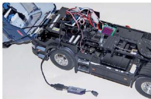
Zur Nutzung des neuen WLAN-Sticks muss eine neue Programmierung installiert werden. Dazu wird die Datei vom Hersteller auf einen normalen USB-Stick kopiert und dieser eingesteckt
