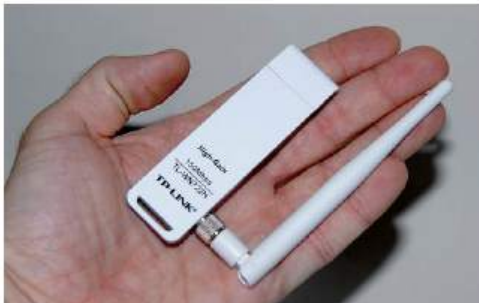
Der neue WLAN-Stick für die erhöhte Reichweite ist deutlich größer als die mitgelieferte Normal-Version
