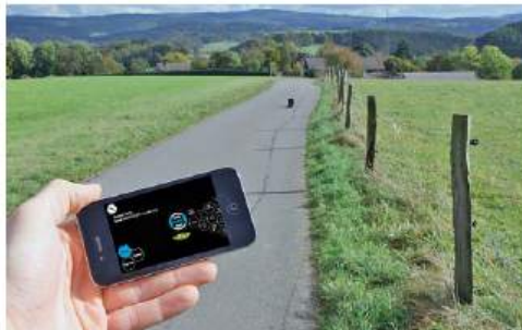
20 Meter Reichweite konnten im Test im freien Feld und bei geladenem Akku erreicht werden, bis die Verbindung abbrach
