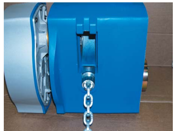
Abb. 4: Schon bei der Fotokomposition ist die Perspektive wichtig: Im Gegensatz zu den kleineren Baugrößen wird der Kettenzug liegend demontiert.
