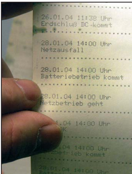
Geplanter Ausfall: In nur zehn Sekunden übernimmt das Notstromaggregat die Versorgung. Foto: Kalcher
