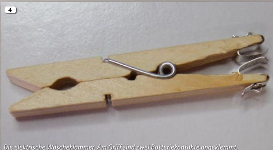
Die elektrische Wäscheklammer. Am Griff sind zwei Batteriekontakte angeklemt.
