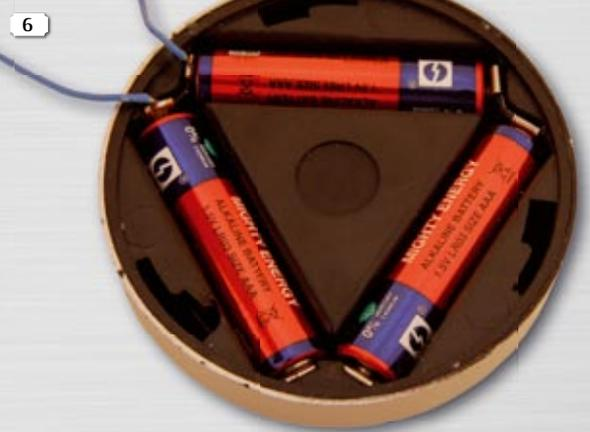
Der Stromkreis ist durch die neuen Kontakte (oben links) unterbrochen. Oben rechts zwei weitere Kontakte, die sich auch für die Unterbrechung eignen würden. Unten die Kontakte für die Verbindung zur Leuchte.
