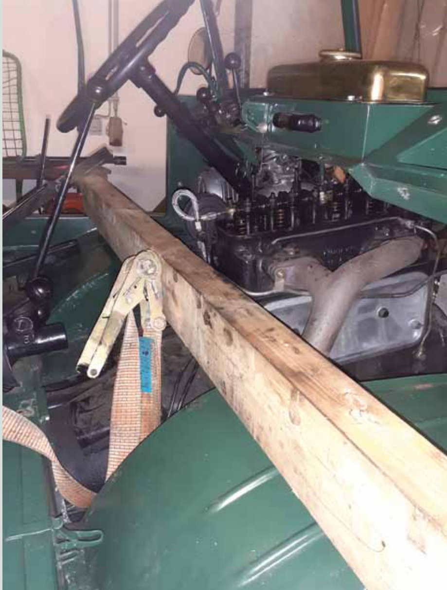
Abbildung 1: Meine Motorhalterung für die Demontage: Ein Holzbalken links und rechts auf dem Einstieg mit Spanngurt zur Sicherung des Motors.
