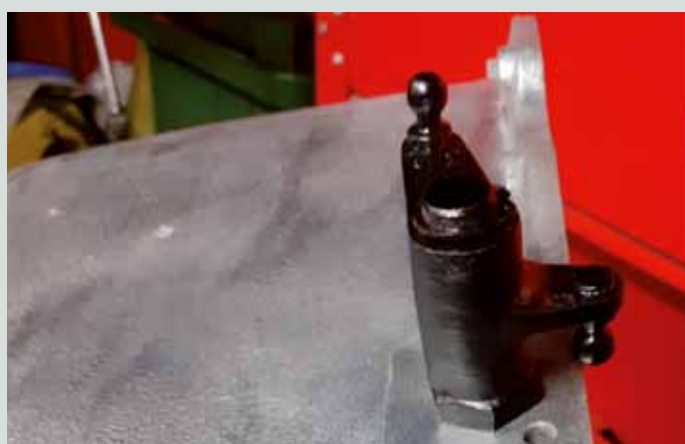
Abbildung 3 und 4: Links die neue Ölwanne mit dem Anguss für die Montage. Rechts die montierten Einzelteile des Umlenkhebels.
