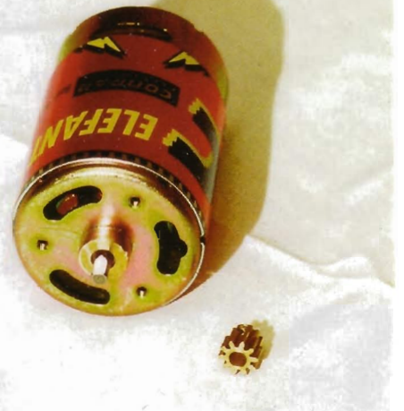
▲ Für den Umbau muss die Welle des Motors angeschliffen und das Originalritzel aufgehohlet werden.
