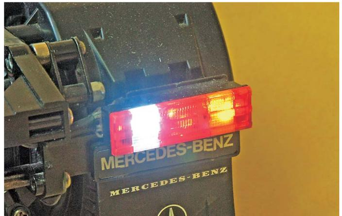
Auch die hinteren Lampen können komplett gesteuert werden: Bremslicht, Schlusslicht, Blinker und Rückfahrcheinwerfer
