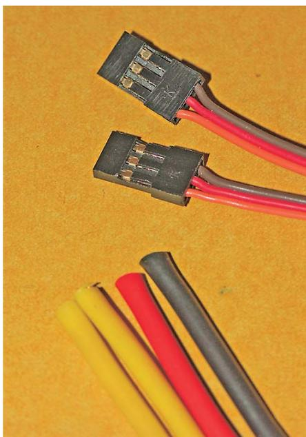
Die Empfängerstecker sind voll kompatibel. Beim Anschluss von Motor und Akku ist jedoch Löten Pflicht
