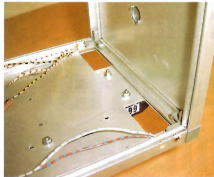
Durch die Alu-Winkel vom Auflieger sind die Löcher von außen unsichtbar
