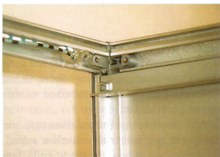
An die Kunststoffhalterungen wird die Spindellagerung geschraubt
