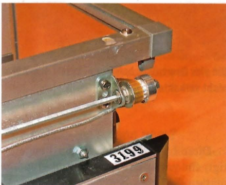
Spindel mit Riemenscheibe und Zahnriemen. Der Antrieb sitzt hinter dem Lager unterhalb des Loches in der Bodenplatte
