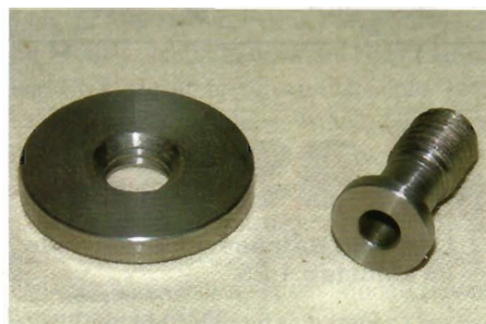
Soll die Übertragung über den Königsbolzen erfolgen, muss dieser innen hohl sein
