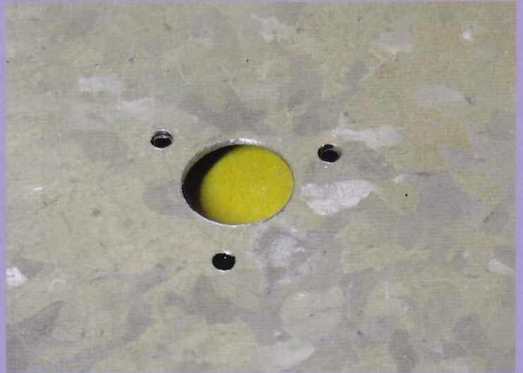
Bohrschablone: Durch die kleinen Löcher wird die Felge angeschraubt
