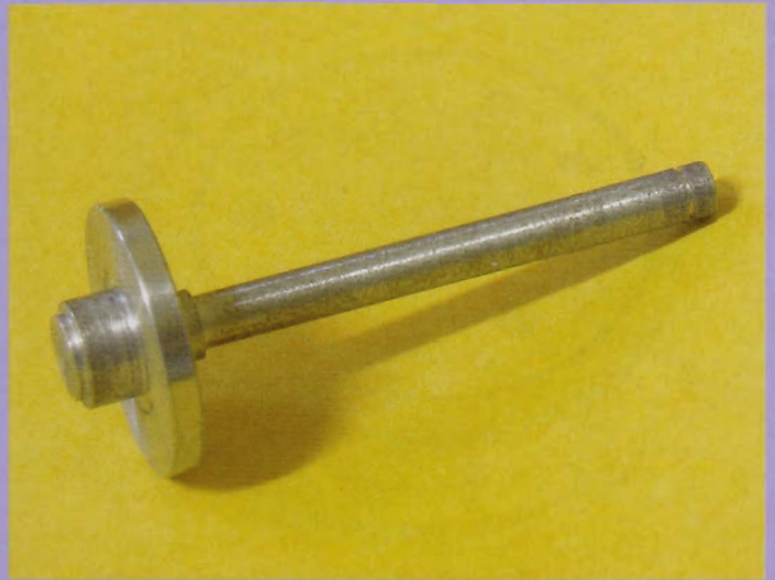
Rund und gut: die selbst gedrehte Achse
