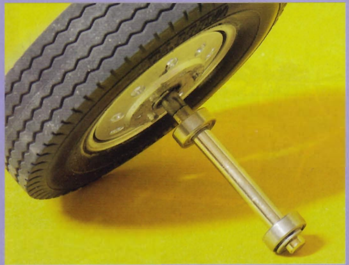
Das eiert: Die Felge wird lediglich gegen den Sicherungsring gedrückt
