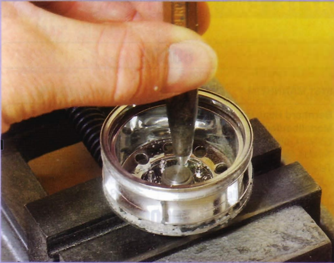
Durch die Felge hindurch werden die Löcher auf dem Flansch angekört
