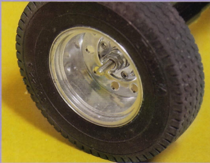
Vorher: An der Original-Tamiya-Achse lässt sich die Single-Bereifung nur schlecht befestigen
