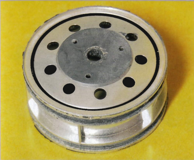
Der Umbau geht los: Vor dem Aufbohren die Rückseite plan schleifen
