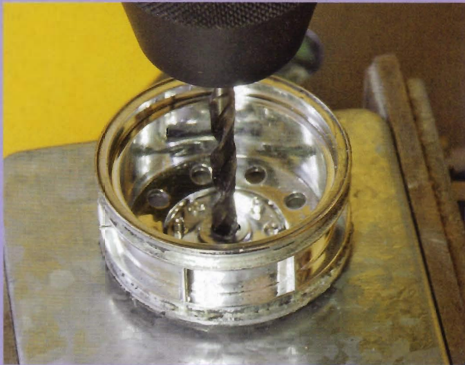
Mit einem 5-mm-Bohrer wird die Felge unter der Bohrmaschine zentriert
