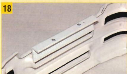
Diese gekürzte Halterung jetzt an den bereits angeklebten Kunststoffwinkel kleben. Die Halterung soll von oben bis zur Kante des Stoßfängers um 11 mm hochstehen.
