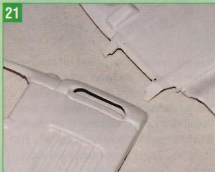
Zunächst sollte noch ein wenig Arbeit in die Eckblenden investiert werden. Mit einer Laubsäge die Hinterschneidung aussägen und die Kanten mit einer kleinen Feile glätten. Auch am Seitenteil ein wenig abfeilen, bis eine Ausnehmung zwischen den beiden Klebelaschen entsteht.
