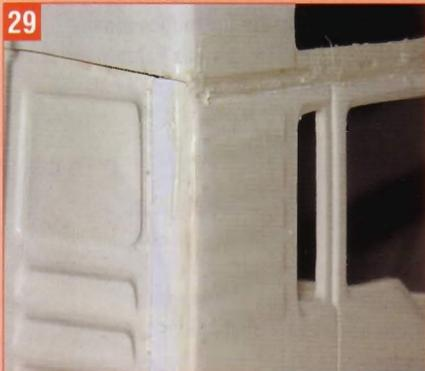
Als kleine optische Korrektur an dieser Kante an der Rückwand einen 2 mm dicken PS-Streifen aufkleben. Dadurch wird die Ecke der Karosserie deutlicher. Auch den PS-Streifen sauber verspachteln.
