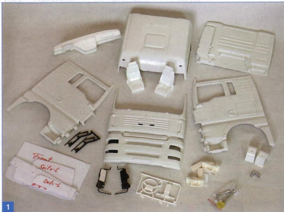
ben, der Innenausbau (bestehend aus einem Armaturenbrett, Sitzen und dem Lenkrad), Scheinwerfer und einige Anbauteile wie Spiegel, Scheibenwischer und Hörner. Zusätzlich enthalten ist eine Grundplatte zur Montage des Fahrerhauses auf dem Rahmen. Die Karosserie ist im Tiefziehverfahren hergestellt und besteht aus PVC – ein Kunststoff, der eine gewisse Spezialbehandlung braucht, aber dennoch gut zu bearbeiten ist.
