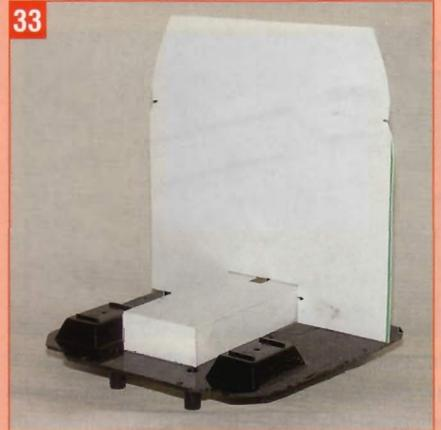
Während die Farbe trocknet, ist Zeit für die ersten Teile des Innenausbau. Aus PS-Kunststoffplatten einen Motortunnel aufkleben ...
