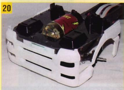
Die insgesamt sechs Löcher der Halterungen jetzt auf die Grundplatte übertragen, bohren und festschrauben.
