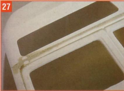
Jetzt einige der Übergänge und Klebekanten verspachteln. Bei großen Spalten zuerst mit einer groben Spachtelmasse, zum Beispiel mit Epoxidharzholzspachtelmasse, füllen.
