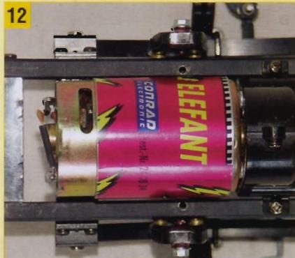
Zwei Löcher zum Anschrauben der Grundplatte bohren. Die Löcher haben einen Abstand von 69 mm zur vorderen Kante des Rahmens. Mit diesem Abstand kann das Fahrerhaus später exakt mittig aufgesetzt werden, damit die Räder genau in der Mitte der vorderen Kotflügel sitzen.
