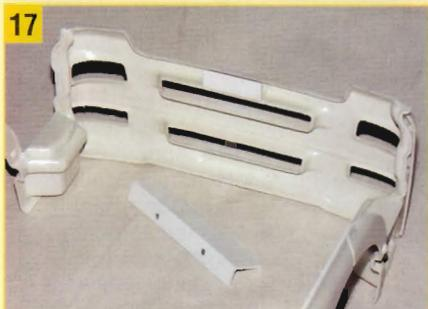
Jetzt muss eine Befestigung für den Stoßfänger gebaut werden. Auf die obere Aussparung wie abgebildet einen kleinen Kunststoffwinkel kleben. Die Halterung, die vorne an der Grundplatte mitgeliefert wurde, etwas kürzen.
