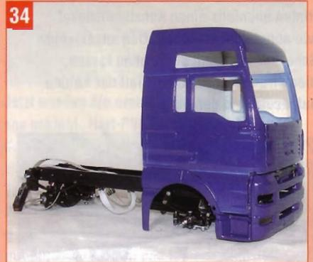
Rahmen mit Antrieb, Achsen und Karosserie sind jetzt fertig.
