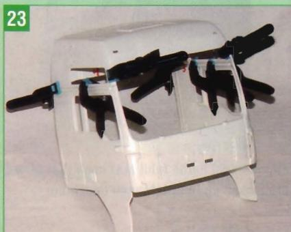
Das Dach an den Seiten, unterhalb des oberen Fensters und am vorderen Holm ankleben. Kleine Klemmen halten das Dach beim Aushärten in Position.
