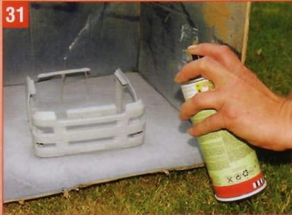
Jetzt wird lackiert. Zunächst Grundierung in zwei dünnen Schichten, dann die gewünschte Farbe in mindestens drei Schichten und schließlich Klarlack in zwei weiteren Lagen auftragen. Zwischendurch in einem staubfreien Raum vollständig trocknen lassen.
