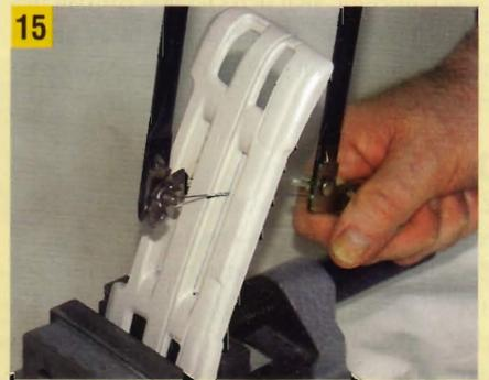
Die Stege aus dem abgetrennten Stoßfänger sägen. Dazu zuerst ein kleines Loch bohren, dann das Sägeblatt der Laubsäge durchfädeln und einspannen. Kunststoffteil sehr vorsichtig in einen Schraubstock spannen oder festhalten.
