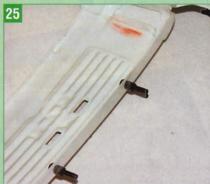
Die Kabine wird hinten von den beiden Kunststoffwinkeln auf dem Unterteil (Bild 19) gehalten. Vorne sorgen zwei Schrauben für den richtigen Sitz. Löcher entsprechend in die Kante unter dem Kühlergrill bohren. Auf die Schrauben einen Schlauch schieben, der das Fahrerhaus mit etwas Abstand auf dem Unterteil hält.
