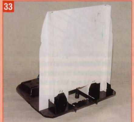
... und mit Kunststoffwinkeln eine passende Trennwand bauen. Hinter diese Trennwand kommen später einige Komponenten der Fernsteuerung und Elektrik.
