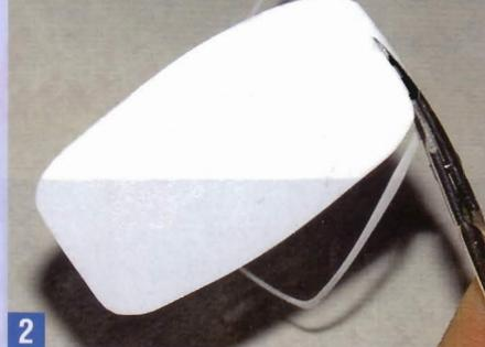
**2** Das Streifenmuster wird mit einer 0,3 mm dünnen Kunststoffplatte nachgebildet. Die Kontur des Auspuffs dazu noch mal ausdrucken und auf die 0,3-mm-Platte übertragen. Mit einer Nagelschere ausschneiden. Dann ringsherum zwei weitere Millimeter von der Kontur abschneiden, damit das Streifenmuster nicht bis an den Rand des Auspuffs reicht.
