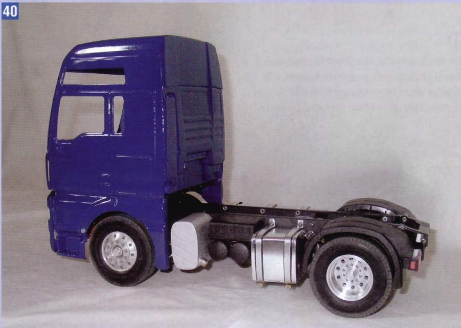
An der linken Rahmenseite zusätzlich Auspuff und Batteriekasten anschrauben. Hier einfach Löcher in den Rahmen bohren und mit je zwei Schrauben befestigen. Den Auspuff am besten von innen mit zwei Holzschrauben sichern. Er muss übrigens etwas schief montiert werden.
