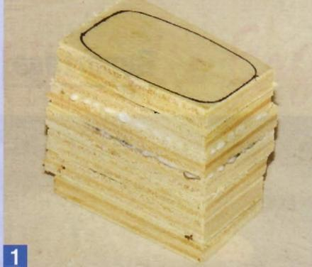
**1** Mehrere Sperrholzplatten mit den ungefähren Maßen des Auspuffs übereinander kleben. Der Stapel sollte eine Höhe von etwa 55 mm haben. Dann die Kontur vom Zeichnungsausdruck übertragen und den Block mit einem Bandschleifer zurechtschleifen.
