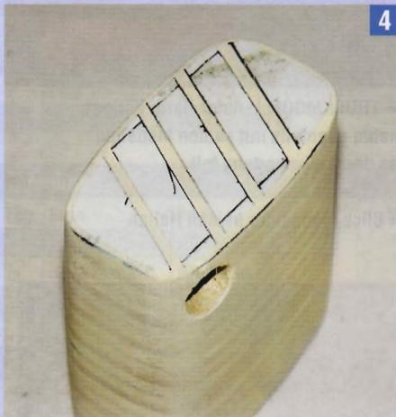
**4** Jetzt die schmalen und breiten Streifen auf die Stirnfläche des Auspuffs legen und verschieben, bis das Muster mittig sitzt. Dann die breiten Streifen mit Sekundenkleber ankleben. Die schmalen Streifen als Abstandhalter dazwischen liegen lassen, aber nicht mit ankleben. Sind alle breiten Streifen befestigt, die schmalen Streifen entfernen.
