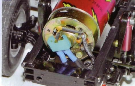
◀ Den (entstörten!) Antriebsmotor ebenfalls mit einem Hochstromstecker an den Servonaut M20T anschließen. Über die Stecker kann bei Bedarf alles leicht wieder ausgebaut werden.
