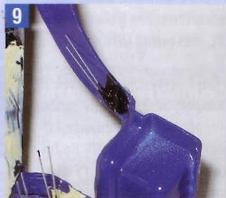
9 Der seitliche Blinker wird bei vielen Modell-LKWs vergessen. Ein 5-mm-Loch bohren und eine gelbe LED einkleben. Schwarze Farbe verhindert, dass die LED in den Innenraum leuchtet.
