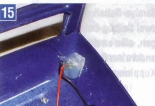
15 ◀ Dann von innen eine LED in die Öffnung schieben und das Loch mit Schmelzkleber auffüllen. Der Kleber fixiert zum einen die Abdeckung sowie die LED und streut zum anderen das Licht. Danach den Tesafilm entfernen.
