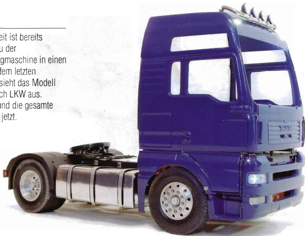
Los geht es mit den Scheinwerfern. Hier enttäuschen die Lampengehäuse von Modellbau Müller leider – ihre Form entspricht nicht der eines echten MAN-Scheinwerfers. Also ist ein Selbstbau angesagt. Weiter geht es mit den Servos. Vier Stück werden benötigt und zwar für Lenkung, Differentialsperre, Sattelkupplung und Getriebeschaltung. Es folgt die Stromversorgung.
