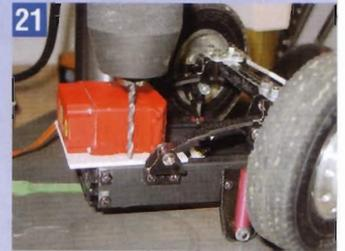
Das Servo vor der Vorderachse auf den Rahmen legen und die bestmögliche Position ermitteln. Dabei unbedingt schon daran denken, wie die Anlenkung zur Vorderachse geführt werden soll. Das Servo steht hier etwa 10 mm über den Rahmen nach vorne hinaus.
