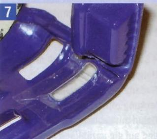
7 Beim Einkleben mit Klebstoff riskiert man, dass etwas auf das Plexiglas tropft. Einfacher ist es, das Glas von hinten mit transparenter Klebefolie in die Karosserie zu kleben.
