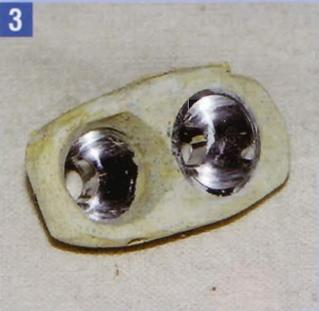
3 Mit einem Mini-Schleifer jetzt die Kontur des Scheinwerfers nachbilden. Die Vorderseite sollte glatt sein und zur linken Seite nach hinten verlaufen. Am besten mehrfach spachteln und schleifen. Scheinwerfer dann silbern lackieren und weiße 5-mm-LEDs einsetzen.
