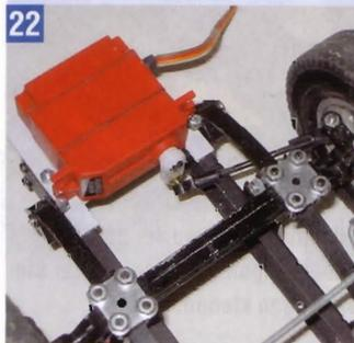
Servo mit zwei Schrauben am Rahmen befestigen. Dann ein Ruderhorn aufsetzen und die Anlenkung zum Vorderrad anpassen. Dabei am besten direkt arbeiten und auf die unzähligen Anlenkhebel verzichten, die Tamiya im Mercedes vorsieht. Je direkter die Anlenkung ist, je weniger wackelt die Lenkung nachher.
