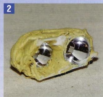
Außen und in alle Öffnungen Spachtelmasse einfüllen. Hier wird 2-Komponenten-Holzspachtelmasse verwendet – sie trägt dick auf und trocknet gut.
