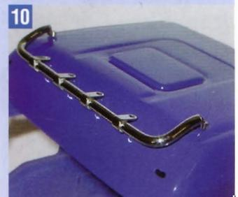
10 Für Nachtfahrten über Deutschlands Autobahnen soll der TGA zusätzliche Dachlampen für das Fernlicht bekommen. Der Lampenbügel samt Leuchten stammt von EBH-Modellbau ([www.ebh-modellbau.de](http://www.ebh-modellbau.de)). Zunächst den Bügel mittig auf dem Dach anschrauben.
