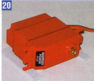
Eine dickere Kunststoffplatte wie hier zurechtschneiden. Sie ist 6 cm breit – passt also genau auf dem Rahmen. Das Servo mit 2-Komponenten-Epoxydharz-Kleber auf die Platte kleben.
