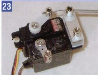
Zwei Mini-Servos mit einem Stück U-Profil nebeneinander schrauben. Ruderhörner aufschrauben und sowohl am Ruderhorn als auch oben im U-Profil je eine Seilzug-Schraube anbringen. Je einen Mini-Seilzug wie gezeigt befestigen. Die Ummantlung an der festen Schraube, den Seilzug am Ruderhorn arretieren.
