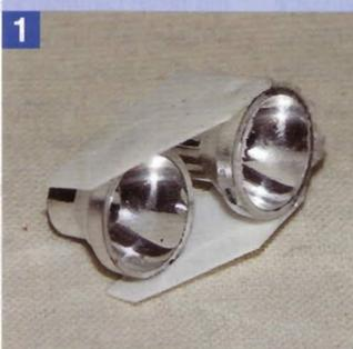
Den Anfang machen die Scheinwerfer. Je zwei LED-Reflektoren (Conrad) mit einem kleinen Stück PS-Kunststoff zusammenkleben. Der linke Reflektor sitzt genau neben dem rechten, jedoch um etwa 5 mm nach hinten versetzt.
