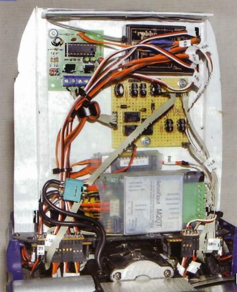
◀ Die Platine #LS einbauen und die Leitungen LSL und LSR (von den Platinen #LL und #LR), die Leitung LS (vom Servonaut) und die Leitung zur Dachplatine LD anschließen. Oben links der 2-Kanal-Tast-Memory-Schalter für Fern- und Nebellicht. Schließlich 11+ und 11- mit einem Hochstromstecker an den Servonaut anschließen.
