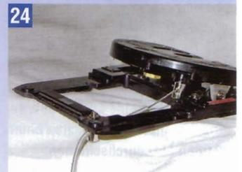
Der andere Seilzug führt zur Tamiya-Sattelkupplung. Auch hier zwei Seilzug-Schrauben anbringen, eine an der Grundplatte, die andere am Betätigungshebel der Kupplung.
