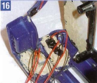
Die Anschlussbeinchen der LEDs kürzen und Kabel anlöten. Das rote Kabel kommt immer an das längere Beinchen (Anode, Plus-Pol) der LED.
