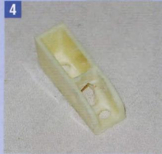
4 Die Nebelscheinwerfer-Gehäuse von Müller müssen nur noch etwas bearbeitet werden. Hier findet hinterher auch der Blinker Platz. Dessen LED soll unauffällig eingesetzt werden – daher diagonal ein 5-mm-Loch bohren und den mittleren Steg mit einer Mini-Fräse verkleinern.
