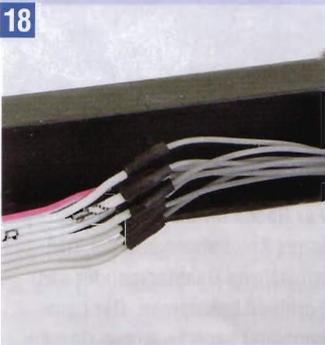
Die Rückleuchten wurden in TRUCKMODELL 1/2007 schon eingebaut. An die dünnen Litzenkabel jetzt (unauffällig im Rahmen versteckt) ein Flachbandkabel anlöten. Es reicht bis zur Vorderachse, dann kommt auch dort ein Pfostenstecker an das Kabel. Auf der linken Fahrzeugseite heißt das Kabel LHL, rechts LHR.
