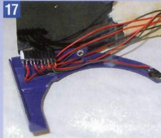
Die Kabel bis zum hinteren Teil des Fahrerhauses führen und einen Pfostenstecker anlöten. Der weiß markierte Stecker ist Ader 1. Damit man hinterher den Durchblick behält, die Stecker beschriften. Das linke Kabel heißt LVL, das rechte LVR.
