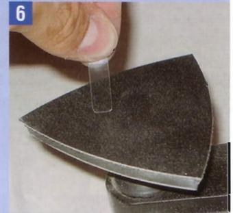
6 Die Scheinwerfergläser von Müller sind schon sehr gut vorgearbeitet. Mit Fingerspitzengefühl die Gläser so bearbeiten, dass sie genau in die Scheinwerferöffnungen an der Karosserie passen. Immer nur wenig abschleifen und immer wieder probieren, ob es passt.
