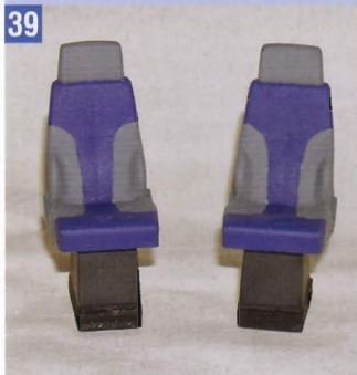
39 Fahrer- und Beifahrersitz werden, wie das Armaturenbrett auch, mit dünnem Leder beklebt. Der Sockel bekommt eine zusätzliche Erhöhung aus Holz und wird schwarz lackiert.
