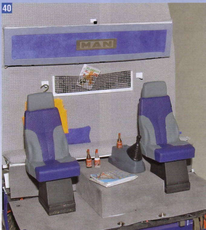
39 Fahrer- und Beifahrersitz werden, wie das Armaturenbrett auch, mit dünnem Leder beklebt. Der Sockel bekommt eine zusätzliche Erhöhung aus Holz und wird schwarz lackiert.
