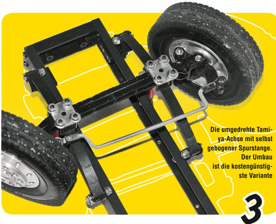
Die umgedrehte Tamiya-Achse mit selbst gebogener Spurstange. Der Umbau ist die kostengünstigste Variante
