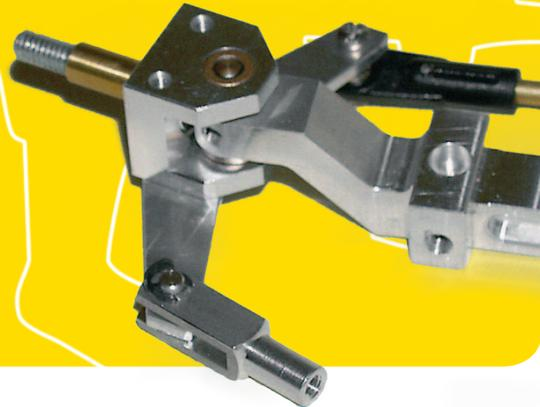
Als Schubstange dient eines der Tamiya-Bauteile. Dann wird die zweite Anlenkung angeschraubt und in das Servohorn gehängt. Bei dieser etwas länglichen Ausführung ist der Bolzen schmaler und passt gut in die zulaufende Spitze des Servohorns. Selbiges ist übrigens aus Aluminium – in Kombination mit einem Metallzapfen am Abtrieb die einzige Chance, spielfrei zu arbeiten. Die gesamte Anordnung ist auf Bild 12 zu sehen.
