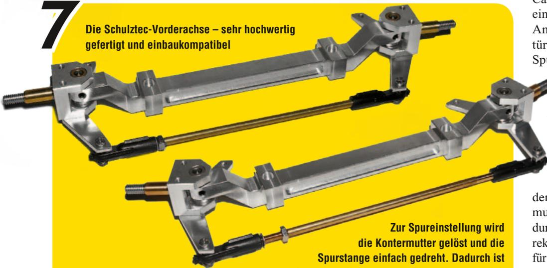
**Zur Spureinstellung wird die Kontermutter gelöst und die Spurstange einfach gedreht. Dadurch ist eine wesentlich genauere Einstellung möglich**
