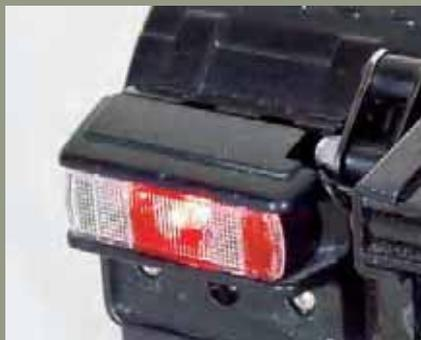
Rücklicht im Kombi-Modus. Durch zwei Helligkeitsstufen werden Rücklicht und Bremslicht in einer LED kombiniert
