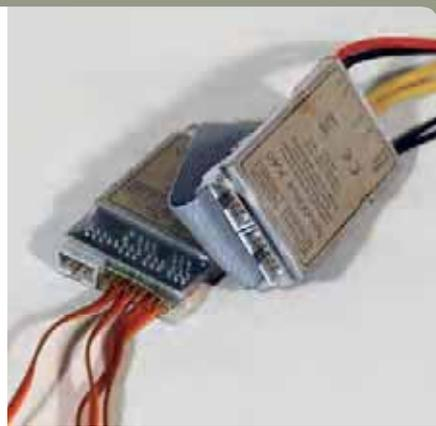
Das Display und die beiden Beleuchtungsplatinen werden über Flachbandstecker angeschlossen. Die vier Kanäle, Servos und Zusatzmodule über einfache Steckverbinder
