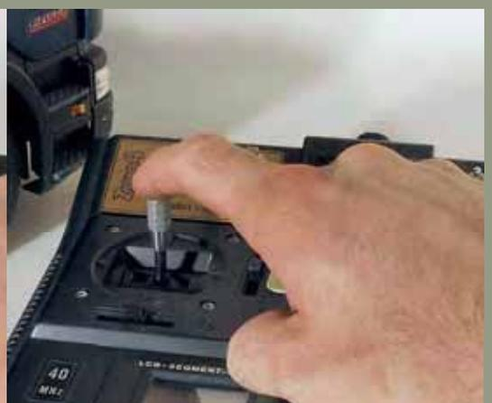
Realistische Blinkerschaltung: Knüppel nach unten-rechts aktiviert den Blinker. Bei der Kurvenfahrt bleibt der Blinker an und schaltet bei Geradeausfahrt automatisch ab
