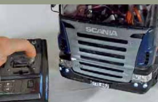
Scheinwerfer im Kombi-Modus: Erste Betätigung schaltet die Standlichter, die es z.B. im Scania nicht gibt. Zweite Betätigung schaltet die Scheinwerfer mit schwacher Helligkeit, oben-rechts mit voller Helligkeit. Rechts-oben schaltet die inneren Scheinwerfer, rechts-unten die Nebellampen
