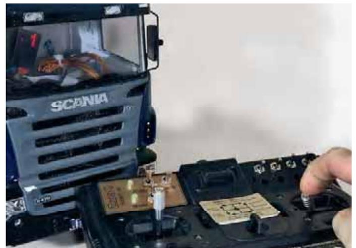
Über den rechten Kreuzknüppel wird geschaltet. Der aktuelle Gang wird im Display angezeigt
