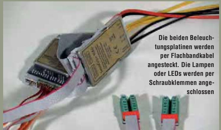
Die beiden Beleuchtungsplatinen werden per Flachbandkabel angesteckt. Die Lampen oder LEDs werden per Schraubklemmen angeschlossen
