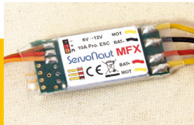
MFX: Regler für Nebenantriebe. Auch hier kein BEC, dafür Plug-and-Play. Beschleunigung und Bremse einstellbar, zudem mit Poti als Servoelektrik nutzbar.
