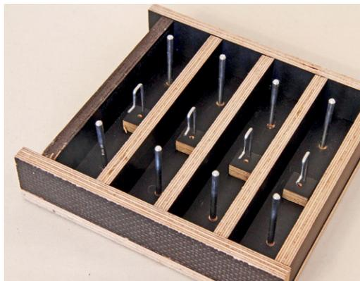
Aus Siebdruckplatten entstand die Schalung der Gegengewichte. Mittig wird ein Haken als Anschlagpunkt eingegossen. Unten bleibt eine entsprechende Ausnehmung zum Stapeln frei
