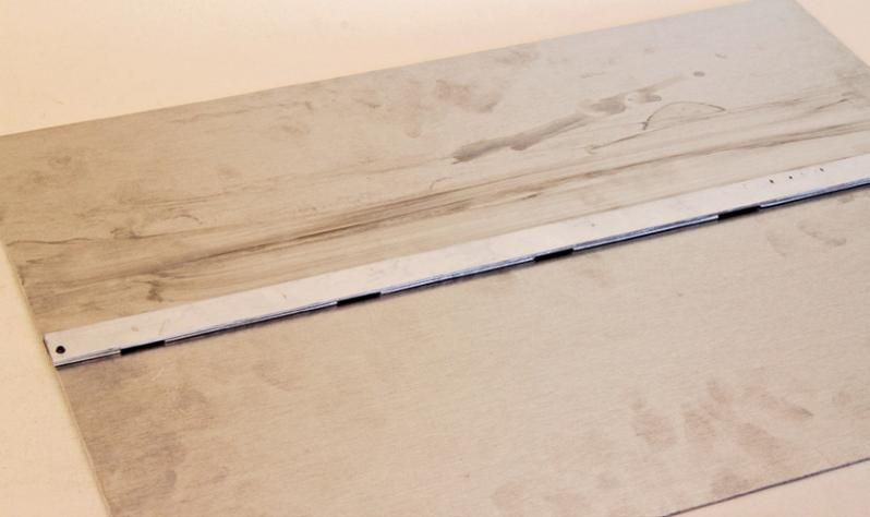
Die Aluleiste verbindet die beiden Hälften des Schildes. In die Taschen werden die Winkel der Masten gesteckt
