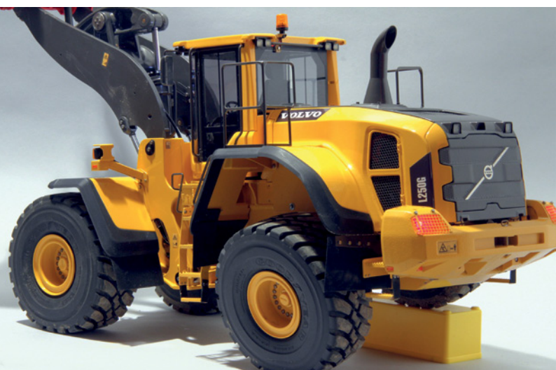
Die Pendelachse ermöglicht einen großen Bewegungsspielraum. Unerlässlich für gutes Vorankommen im Gelände
