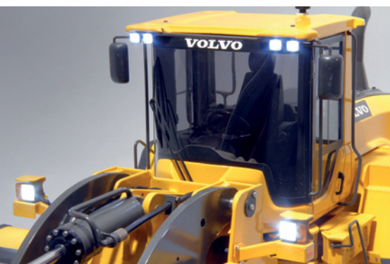
Abblend- und Fernlicht sowie die Blinker sitzen in den seitlichen Halterungen. Oben an der Kabine gibt es bis zu vier Zusatzscheinwerfer
