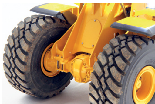
Die Vorderachse ist fest am Rahmen montiert. Auf Wunsch kann sie mit Sperre bestellt werden
